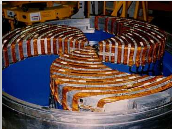
AGOR, Zyklotron zur Untersuchung von Umweltproben, Durchmesser 2m, 35 Tonnen CNRS = Centre National de la Recherche Scientifique
