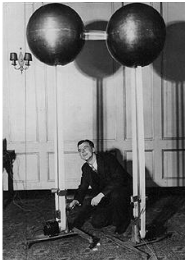
Abbildung 62: Einer der frühen Van de Graaff-Generatoren demonstriert von Robert J. Van de Graaff 21
