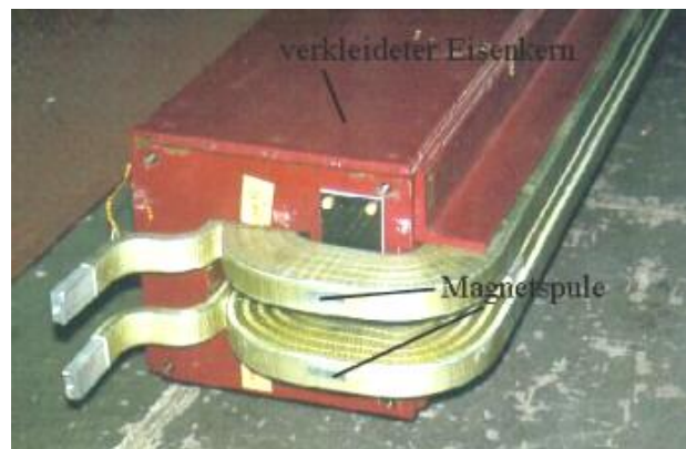
Abbildung 98: Dipolmagnet: Eisenkern und zwei getrennte Magnetspulen mit ihren Wicklungen und Anschlüssen. 28
